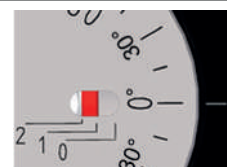
Indicador en posición 2 / Presión alta Stop in position 2 / High pressure
